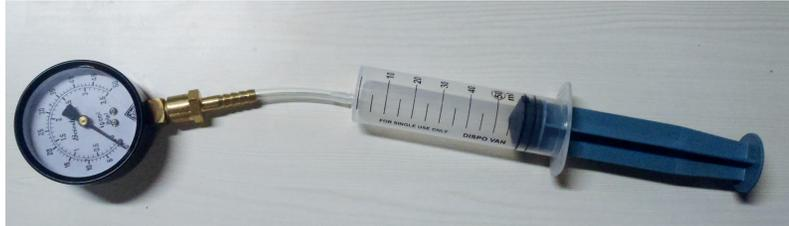
La loi de Boyle-Mariotte est très facile à vérifier, elle nécessite un matériel élémentaire : une seringue et un manomètre. Il suffit de faire varier le volume intérieur de la seringue en poussant le piston et de lire la pression sur le manomètre pour chaque volume. En pratique, l'hypothèse de la température constante est vérifiée, car le temps caractéristique pour atteindre l'équilibre thermique est très court sur un petit volume de ce type.
