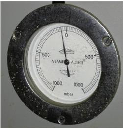
**Manomètre de pression relative :** la pression nulle absolue correspond à  $-1\,000$  mbar si la pression atmosphérique est de 1 bar.
