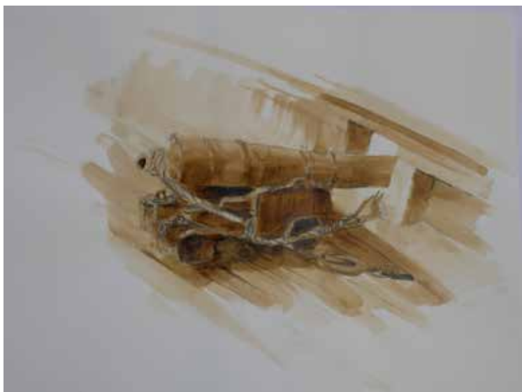
Canon de sabord, relié au pavois par un garant et amarré contre le recul par un cordage appelé brague.
